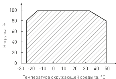
Рис. 2. Максимальная допустимая нагрузка, % от мощности источника
